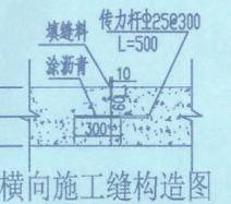
横向施工缝构造图
